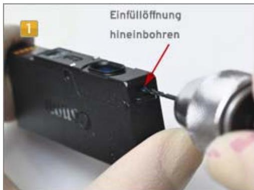
Canon PGI-550, CLI 551 Einfüllöffnung bohren
