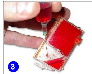
Bohren Sie mittels der rosafarbenen Spritzenadel, durch mehrfaches hin- und herdrehen, ein Loch in die Seite der Tintenkammer (siehe Bild 2). Das Loch wird nach dem Nachfüllvorgang wieder zu geklebt.
