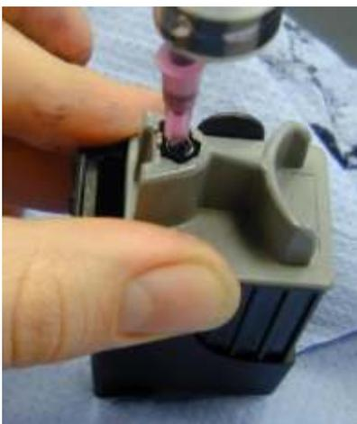
3. Wenn an der Einfüllöffnung der Patrone Tinte wieder austritt, ziehen Sie ca. 1ml Tinte wieder ab. Verschließen Sie die Öffnung wieder mit dem Stopfen.
