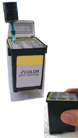
Füllen Sie mit der beiliegenden Spritze maximal die oben angegebene Menge in die jeweilige Kammer der Patrone. Wenn der Schwamm sichtbar übersättigt ist, ziehen Sie etwas Tinte wieder ab. Nehmen Sie die Patrone aus dem Halter und tupfen Sie die Düsen auf einem saugfähigen Stück Papier ab, bis der Abdruck klar erkennbar ist. Bei zu hohem Druck in der Patrone ziehen Sie etwas Tinte wieder ab. Unter der Patrone dürfen sich die Farben nicht vermischen!
