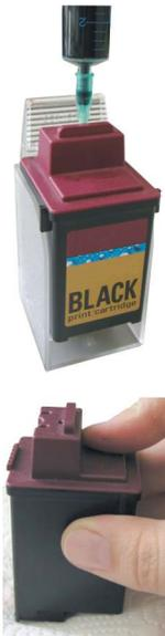
Füllen Sie mit der beiliegenden Spritze und der grünen Nadel maximal die oben angegebene Menge Tinte in die Patrone. Wenn aus dem Füllloch Tinte austritt, ziehen Sie ca. 1 ml Tinte wieder ab. Nehmen Sie die Patrone aus dem Halter. Zu hohem Druck in der Patrone können Sie beseitigen, indem Sie etwas Tinte aus der Patrone abziehen. Tupfen Sie die Patrone auf einem saugfähigen Tuch ab, bis der Abdruck klar erscheint.
