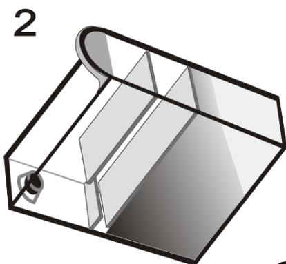
Achten Sie auf korrekten Sitz des Schwammes am "Einfüllloch", sonst zieht der Drucker Luftblasen zu den Düsen und druckt streifig. (evtl. korrigieren)
