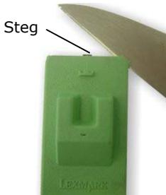
Lösen Sie die Kappe der Patrone mit einem stumpfen Messer und brechen Sie die Kappe seitlich mit einer Zange ab. Der Steg darf dabei nicht beschädigt werden.
